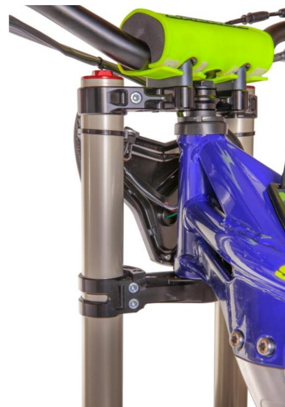
FR : Design optimisé pour gain de poids de 4% soit 29 grammes / Vis de bridage intégrés à l'arrière pour épurer la face avant / Butées de direction sur tés de fourche
