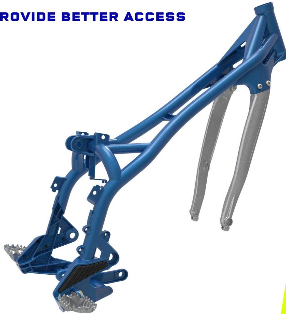
FR : Tube chromolydène et éléments de micro fusion mécanosoudés par robot 1 000 000 cycles de test qualité / Montants latéraux en aluminium forgés démontables pour faciliter la mécanique / Protections de cadre intégrées en polymère
