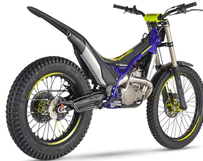
FR : Echappement : Silencieux avec volume interne augmenté de 35% pour apporter force couple stabilité et durabilité / Fibres comprimées thermoformées pour meilleure stabilité dans le temps / Silencieux Démontage facile du silencieux pour changement de fibre
