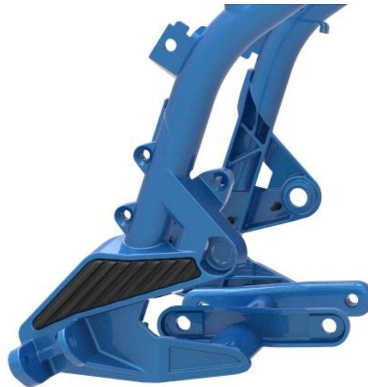
FR : Nouveau groupe repose pieds en micro fusion en acier / Amélioration de stabilité centrale et augmentation du grip / Meilleure évacuation de la boue / Position de conduite améliorée / Fixation de l'axe sans écrou / Butée de cales pieds anti affaissement (Par appuis sur platine micro fusion par dessous)
